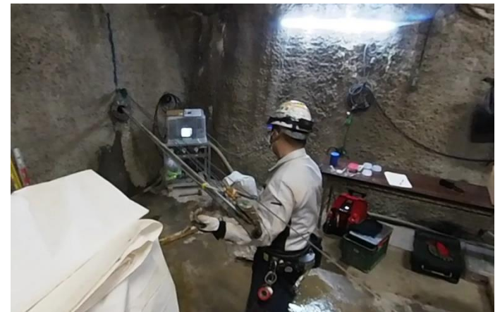
ボーリング孔閉塞試験 (ベントナイトブロックの充填作業)
